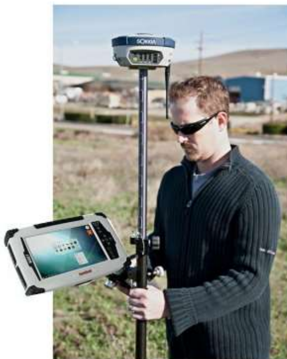
Obr. 9 Přenosný přijímač GNSS s tabletem pro mapování v terénu ( http://www.gaugesandgadgets.com/GRX2 Sokkia RTK Network Rover Kit GNSS GPS Surveying Construction GIS System Carlson Supervisor Tablet PC SurvCE Collector-8-75-288.html )
