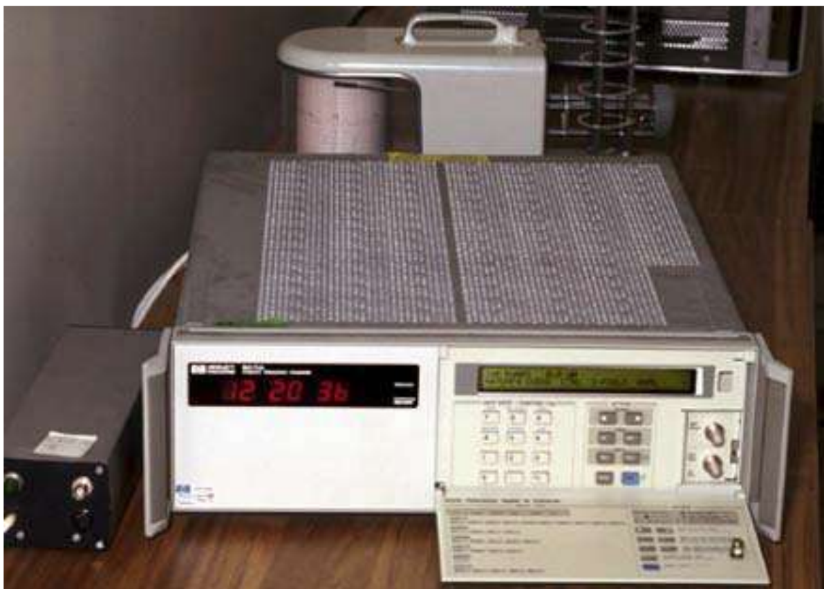
Obr. 51 Ukázka praktické realizace atomových hodin (HP 5071A (BIMP 2002))
